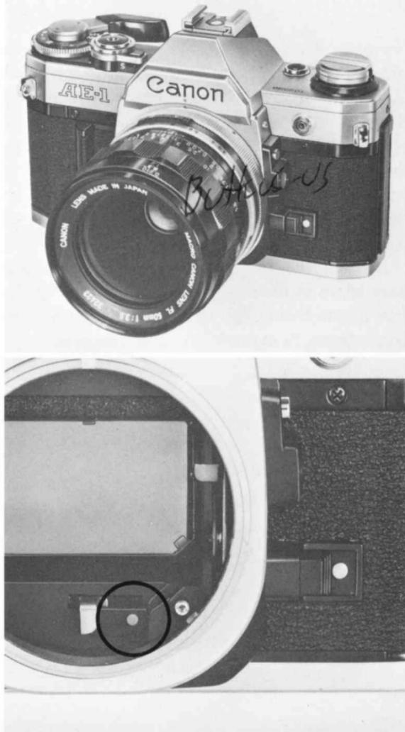
**correcta.** En tal caso, una señal de alarma roja próxima a la palanquita de acoplamiento de diafragmación del objetivo dentro del cuerpo de la cámara queda visible. Después de separar el objetivo de la cámara, en la parte de abajo de ésta, justo debajo del espejo, se ve la palanquita de acoplamiento de diafragmación del objetivo, tal como es el caso de la marca roja en la situación descrita anteriormente.
