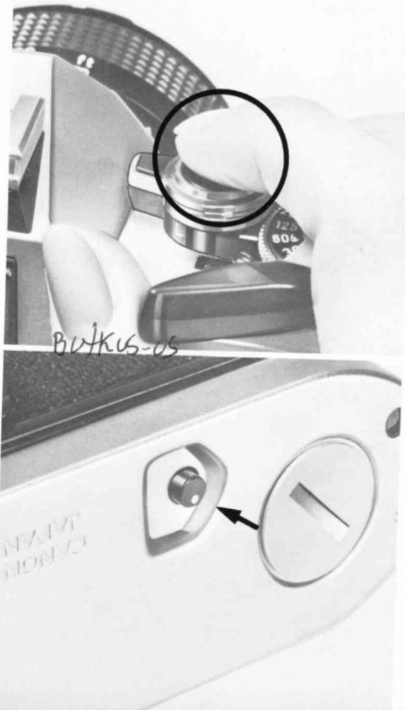
Para rebobinar la película, oprima el botoncito de rebobinado que hay en la parte de abajo de la cámara, despliegue la palanquita de rebobinado hacia afuera y gírela en la dirección de la flecha marcada ahí. Cuando el cuentafotogramas ha llegado a "S", deje de rebobinar. Luego, tire de la palanquita de
